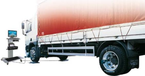
Tramite due rilevatori anteriori con 4 sensori CCD a raggi infrarossi e due trasmettitori a raggi infrarossi posteriori, permette di effettuare in modo rapido e preciso il controllo di tutti gli angoli caratteristici sull'asse anteriore, e in due operazioni il controllo di tutti gli angoli in un veicolo commerciale a due assi. Ripetendo tale operazione, grazie alla lunga gittata degli emettitori, è inoltre possibile la verifica degli angoli in veicoli a più assi o a più assi sterzanti.
