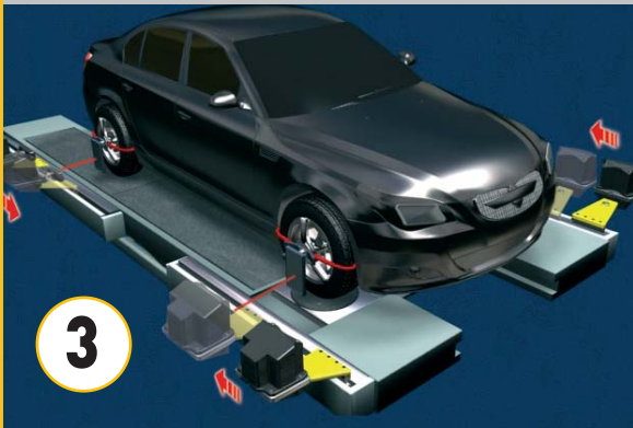
Positionnement automatique des têtes et mesure des angles directs Automatic positioning of measuring heads and measurement of direct angles Posicionamiento automático de los captadores y medición de los ángulos directos
